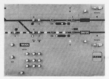
Bild 3. Zugsnummer im Streckenbild mit Zugsnummer-Einwahlstelle
