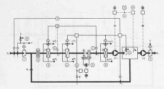
Bild 34. Prinzipschema der automatischen Regelung für das Klimagerät des Photoateliers (Gruppe d)
