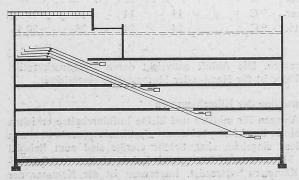
Bild 38. Anordnung der Steigbänder für den Büchertransport, 1:800
