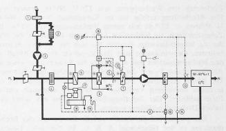
Bild 35. Prinzipschema der automatischen Regelung für die Klimaanlage des Tresors (Gruppe d)
