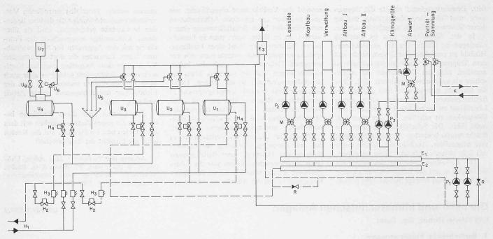
Bild 30. Vereinfachtes Leitungsschema der Heizzentrale
