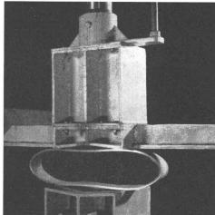
Duktile Gußrohre sind verformbar, bruchfest und korrosionsbeständig
