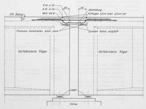
Bild 4. Schnitt durch den Übergang des Bünztal-Viadukts
