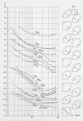
Bild 12. Umlenk-Druckverluste (Ziffern  $\zeta$ ) für 17 verschiedene 90 °-Hochkantkrümmer nach den Bildern 9a, 9b und 10. Die Krümmer sind gekennzeichnet durch die Radien (Angaben in cm, zugeordnet zu  $H=20\,\mathrm{cm}$  und  $B=10\,\mathrm{cm}$ ; leicht umzurechnen für Rohre mit geometrisch ähnlichen Abmessungen)
