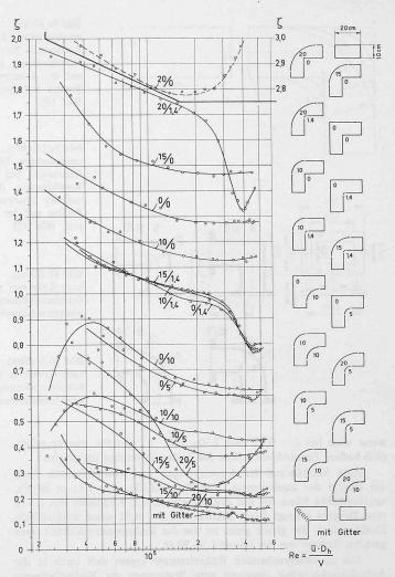
Bild 11. Umlenk-Druckverluste (Ziffern  $\zeta$ ) für 17 verschiedene 90 °-Breitkantkrümmer nach den Bildern 8a, 8b und 10. Die Krümmer sind gekennzeichnet durch die Radien (Angaben in cm, zugeordnet zu  $B=10\,\mathrm{cm}$  und  $H=20\,\mathrm{cm}$ ; leicht umzurechnen für Rohre mit geometrisch ähnlichen Abmessungen; für den Krümmer 20/0 gilt die  $\zeta$ -Skala rechts oben)
