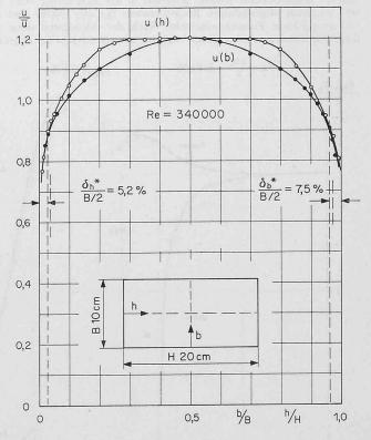
Bild 3. In Mittelschnitten des Rechteckrohres gemessene Geschwindigkeitsprofile mit Angabe der durch Integration bestimmten lokalen Grenzschicht-Verdrängungsdicken ( $\delta*$ ) bei  $R_e=340\,000$
