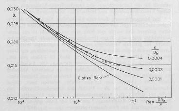
Bild 2. Ausschnitt aus dem Moody-Diagramm zum Berechnen der Druckverluste in runden, geraden Rohren bei ausgebildeter Geschwindigkeitsverteilung und unterschiedlicher Wandrauhigkeit  $(\varepsilon)$  nach der Gleichung
