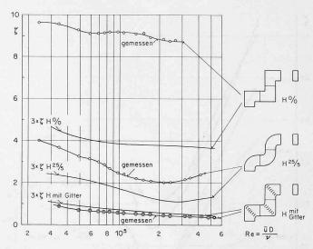
Bild 13. Beispiele der Kombination von drei Arten unter sich gleicher Hochkantkrümmer (H) ohne Zwischenrohre: Messergebnisse im Vergleich zu den mit drei multiplizierten Druckverlusten der Einzelkrümmer
