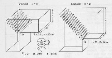
Bild 10. Zwei Krümmer mit einfachen Blech-Umlenkgittern; Winkelübertreibung auf der Eintritts- und Austrittsseite je 5 ° (vgl. Bilder 11 und 12)
