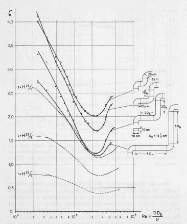
Bild 15. Ergebnisse von drei, mit unterschiedlich langen Zwischenrohren in Serie geschalteten Hochkantkrümmern (H) mit Angabe des  $\zeta$ -Verlaufes eines Einzelkrümmers und den mit 2 und 3 multiplizierten  $\zeta$ -Werten. Bemerkenswert ist die starke Abhängigkeit der  $\zeta$ -Werte von der Reynoldszahl
