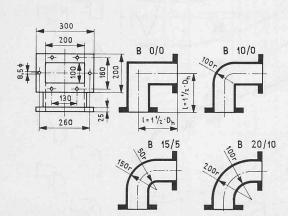
Bild 8a (links). Abmessungen der untersuchten 16 Breitkant-90 °-Krümmer. Sie entstehen durch Kombination der vier Radien auf der Innenseite mit den vier Radien auf der Aussenseite (vgl. Bild 10)
