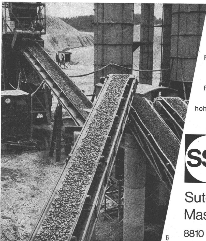
Die Belags- und Betonproduktion kann durch Einsatz geeigneter Förderbänder entscheidend rationalisiert werden. Hier verhelfen SSS-Förderbänder, zentral ferngesteuert und unaufhörlich strapaziert, zu einer konstanten hohen Produktion.
