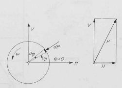
Bild 6. Vom Schmiermittel auf die Welle ausgeübte Druckkraft
