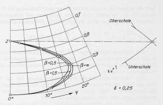
Bild 10. Berechnete Wellenlagen in Zitronenspiellagern mit verschiedenen relativen Breiten  $\beta$  und festem Spielverhältnis  $\delta=0.25$
