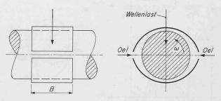
Bild 1. Schematischer Aufbau des Zitronenspiellagers
