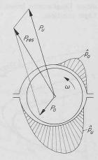
Bild 7. Segmenteinzelkräfte und Resultierende beim Zitronenspiellager
