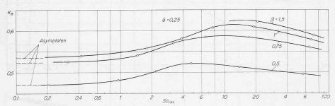
Bild 17. Berechneter dimensionsloser Schmierstoffdurchsatz von Zitronenspiellagern mit relatigen Breiten  $\beta$  und festem Spielverhältnis  $\delta=0.25$
