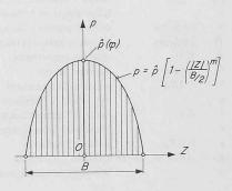
Bild 4 (rechts). Axiale Druckverteilung in einem Schmierspalt
