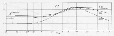
Bild 16. Berechneter dimensionsloser Schmierstoffdurchsatz von Zitronenspiellagern mit verschiedenen  $\delta$ -Werten bei konstanter relativer Breite  $\beta$
