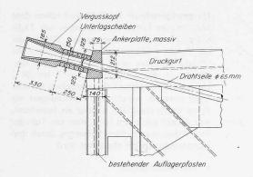
Bild 5. Detail der Seilverankerung, 1:25
