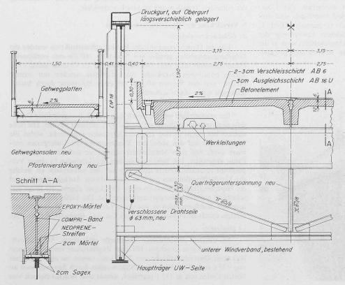
Bild 1. Querschnitt, 1:50
