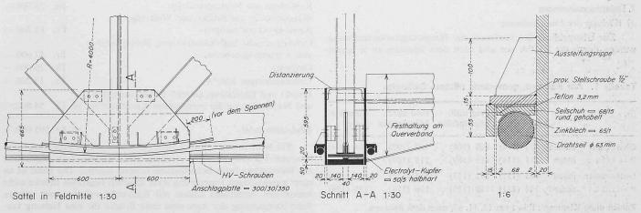
Bild 7. Details der Seilauflagerung
