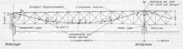
Bild 3. Statisches System der unterspannten Brücke, 1:400
