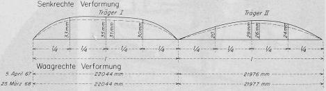
Bild 6. Verformung der Träger nach einem Jahr unter  $p=0.3\ t/m^1\ Nutzlast$
