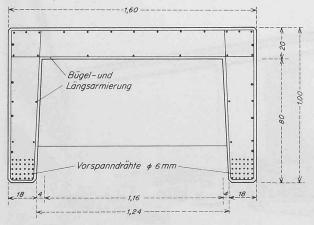
Bild 4. Trägerquerschnitt 1:25
