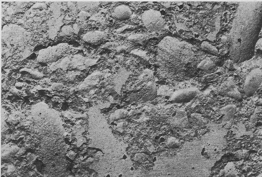
Bild 2. Nahaufnahme eines Bruches in der Grenzschicht. Typisch ist die einseitige Freilegung der mittleren und grösseren Zuschlagskörner und das Auftreten von schuppenartigen Kleberresten, welche manchmal noch mit einer äusserst feinen Zementschicht bedeckt sind
