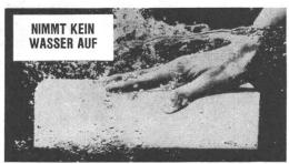
Legen Sie ein Stück Styrofoam ins Wasser. 5 Minuten oder 5 Wochen. Wenn Sie es herausnehmen, werden Sie sehen: unverändert. Schneiden Sie es auf: trocken – durch und durch.
