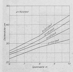
Bild 6. Erforderliche Dicken von Flachdecken mit Stahlpilzen
