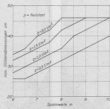
Bild 7. Stützenabmessungen für Flachdecken mit Stahlpilzen
