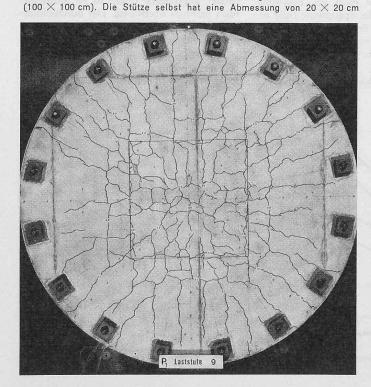
Bild 2. Rissebildung im Stützenbereich einer Flachdecke mit einbetonier-
