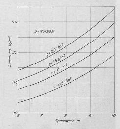
Bild 8. Armierungsverbrauch in Flachdecken mit Stahlpilzen
