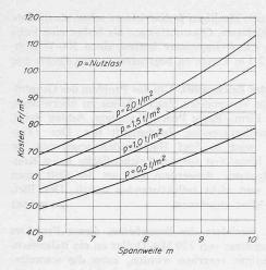
Bild 9. Kosten der Flachdecken mit Stahlpilzen (ohne Stützen)
