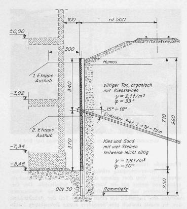
Bild 11. Spriessungsfreie Baugrube mit Rühlwand 1:125
