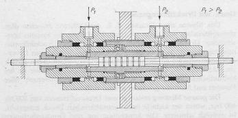
Bild 14. Schnitt durch ein Kolbenmanometer
