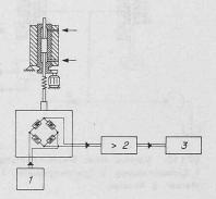
Bild 11. Druckmesser mit elektrischer Messeinheit
