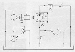
Bild 30. Hydromotorantrieb. Die für den Versuch benötigte Energie wird von einem Hydromotor geliefert. Die Drehzahleinstellung erfolgt durch Änderung des Hubvolumens einer hydraulischen Pumpe, die Druckeinstellung durch einen verstellbaren hydraulischen Widerstand
