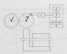
Bild 4. Wägemessung. 1 Verstärker, 2 Oszillator, 3 Torschaltung, 4 Anzeiger
