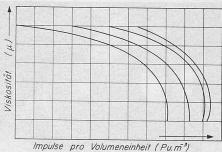
Bild 7. Verlauf der von einem Turbinen-Durchfluss-Messgerät abgegebenen Impulszahl pro Volumeneinheit in Funktion der abgegebenen Impulszahl pro Zeiteinheit. 1 Idealkurve, 2 wirkliche Kurve
