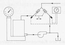
Bild 2. Messung mittels Wägung; Zeitmessung mit Stoppuhr
