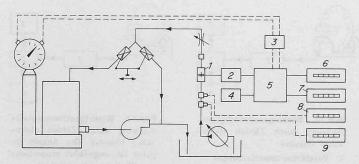
Bild 10. Schema einer Eicheinrichtung mit Turbinen-Durchfluss-Messgerät
