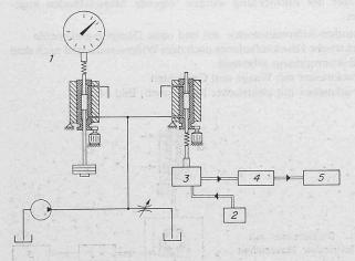
Bild 15. Schema einer Messeinrichtung mit Kolbenmanometer 1 Eicheinrichtung, 2 Spannungsquelle, 3 Kraftmessdose, 4 Verstärker, 5 Anzeige
