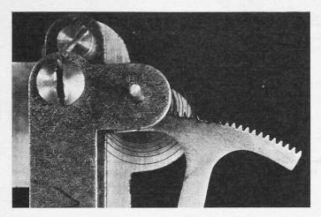
Bild 12. Infolge mikrodynamischer Effekte zerstörtes Übertragungssegment eines Bourdon-Rohrmanometers
