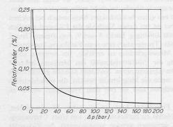
Bild 13. Erzielbare Messgenauigkeit mit einem Kolbenmanometer
