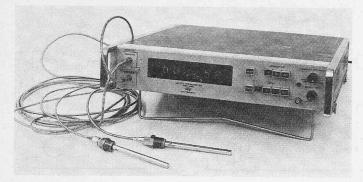
Bild 24. Mit elektronischem Anzeigegerät kombinierte Quarzthermometer
