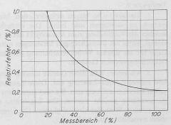
Bild 23. Messungenauigkeit mit dem Verfahren nach Bild 21 in Funktion der Ausnutzung des Messbereiches
