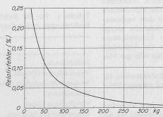
Bild 5. Relativfehler-Kurve einer Präzisionswaage
