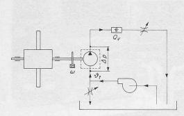
Bild 29. Anordnung mit einem Elektromotor mit Drehzahlregelung. Hier muss die gesamte, für den Versuch notwendige Energie vom Elektromotor geliefert werden. Die Druckeinstellung erfolgt mit einem verstellbaren hydraulischen Widerstand
