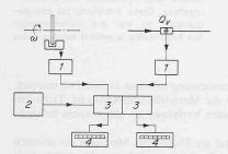
Bild 25. Anordnung für das gleichzeitige Messen der Winkelgeschwindigkeit und des Volumenstroms
