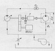
Bild 31. Kreislaufanordnung mit einem Elektro- oder Hydromotor mit Drehzahlregelung. Diese Schaltung ist energiesparend, da nur die Verlustenergie des Kreislaufes zugeführt werden muss
