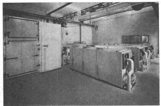
Beton-Frostanlage in der Empa
