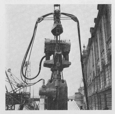
Ziehen zu konstruieren. Ein 10-kW-Elektromotor mit Unwuchten, über einem Federsystem montiert, erteilt dem Schlagteil bei 740 U/min 370 Schläge. Je nach Widerstand der Spundbohle können diese Schläge bis zu 110 t betragen.
