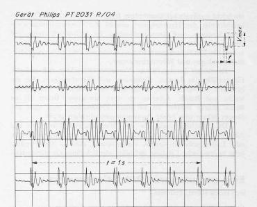
Bild 5. Schwingungsverläufe in drei Richtungen, vertikal, horizontalparallel und horizontal-senkrecht zur Spundwand. Bemerkenswert ist die kurzzeitige Geschwindigkeitsspitze beim Beginn jedes Schlages
