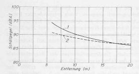
Bild 3. Schallpegelverlauf beim Schlagen und Ziehen von Einzelbohlen Grösse III. Höhe ab Boden 7,0 m. 1 Schlagen mit Vibroramme VM 101, 2 Ziehen mit Vibroramme VM 102
