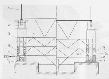
Bild 4. Schematische Darstellung des Absenkvorganges bei der Autobahnbrücke über die Vevevse
