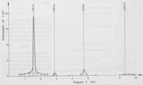
Bild 3. Frequenzspektrum der Brücke. Schwingungserregung durch zwei Erreger in Brückenmitte
