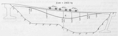
Bild 1. Schematische Darstellung der statischen Biegelinie
