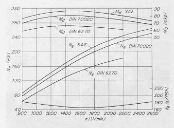
Bild 1. Leistung, Drehmoment und spezifischer Brennstoffverbrauch in Funktion der Drehzahl für beide Ausführungen
