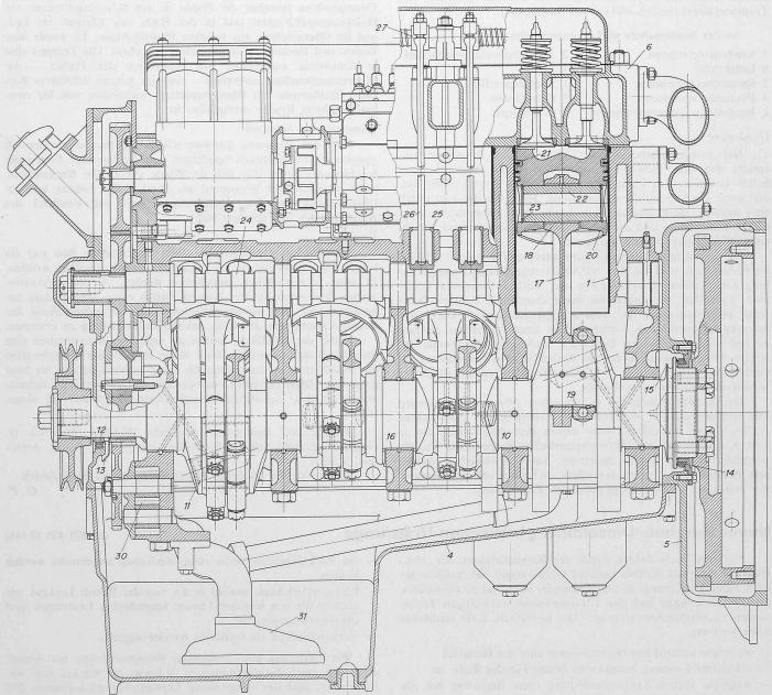
Bild 2. Längsschnitt durch den AEC-Leyland-Dieselmotor, Massstab 1:6
