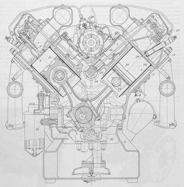
Bild 3. Querschnitt durch den neuen Kurzhub-Dieselmotor, Massstab 1:6
