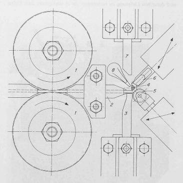
Bild 6. Werkzeuganordnung für das Winden von Federn mit kleinem Aussendurchmesser und engem Wickelverhältnis
