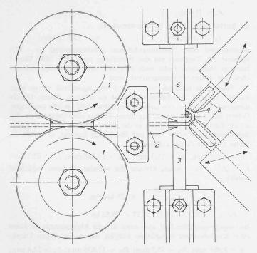
Bild 4. Übliche Werkzeuganordnung am Federwindeautomat
