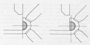
Bild 5. Verschiebung der Federachse in bezug auf den Abschneidedorn zum Zwecke der Querschnittvergrösserung. Links übliche Anordnung, rechts verschobene Anordnung
