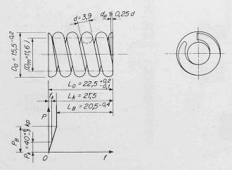
Bild 3. Feder für Kupplungs-Drehschwingungsdämpfer
