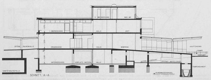
Querschnitt 1:400 (Schnittlage A-A siehe Erdgeschossgrundriss). Links Anschluss der Sanitätshilfsstelle
