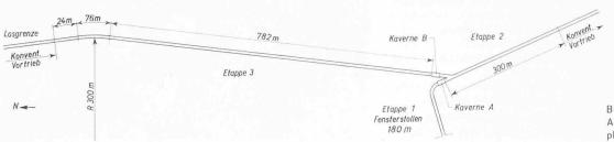
Bild 2. Juliawerk Tiefencastel: Ausschnitt aus dem Schemaplan des Druckwasserstollens
