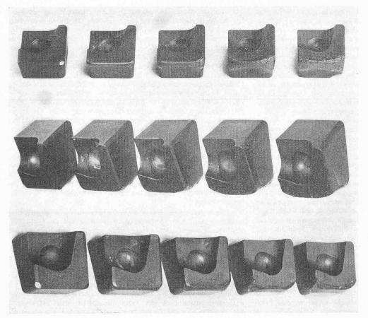
Bild 6a. Zunehmender Verschleiss an der radial arbeitenden Hauptschneidkante von 0 bis 40 m Strecke
