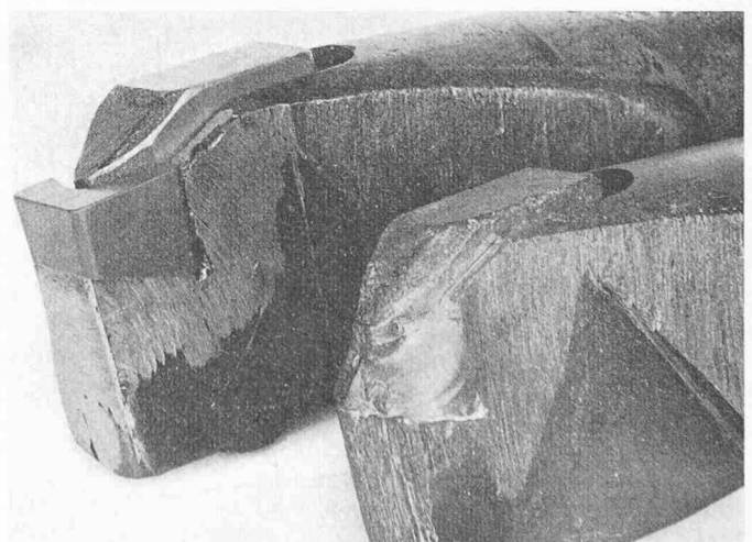
Bild 8. Im Vordergrund ein Fräsmesser, dessen Hartmetallschneide nach übermässiger Abnützung gebrochen ist. Dahinter ein nach Auftragschweissung, Schleifen und Neubestückung wieder zum Einsatz bereitest Fräsmesser
