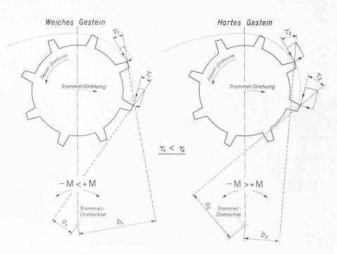
Bild 9. Gegenüberstellung der von einem Fräser auf die Trommel rückwirkenden Kräfte in weichem und hartem Gestein
