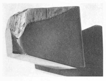
Bild 8. Im Vordergrund ein Fräsmesser, dessen Hartmetallschneide nach übermässiger Abnützung gebrochen ist. Dahinter ein nach Auftragschweissung, Schleifen und Neubestückung wieder zum Einsatz bereites Fräsmesser
