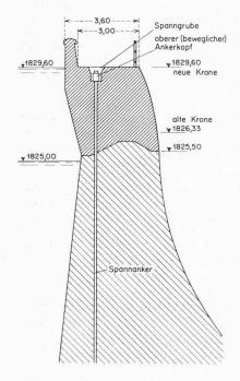
Bild 1. Spullersee-Talsperren, Aufhöhungsquerschnitt 1:200
