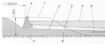
Bild 2. Querschnitt durch das Verkippungsgebiet. 1 Profil nach dem Verkippen, 2 nach dem Ausbreiten des Abbaumaterials, 3 Abdeckschicht aus Sand, 4 Ufermauer, 5 Flut, 6 Ebbe, 7 ursprünglicher Meeresgrund, 8 Abbaumaterial
