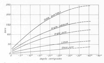
Figure 1. Résistance à l'écrasement de quelques sols en fonction de la température (d'après Mohr)
