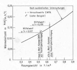
Bild 4. Wärmeleitzahl von Gasbeton in Abhängigkeit vom Raumgewicht
