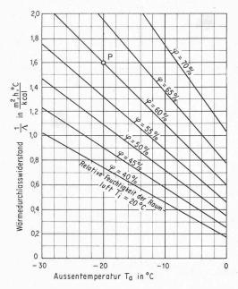
Bild 1. Minimaler Wärmedurchlasswiderstand einer einschichtigen Wand, der erforderlich ist, damit bei einer Temperatur der Raumluft von 20  $^{\circ}$ C in den Ecken keine Kondensation auftritt. Beispiel (Punkt P): Bei einer Aussentemperatur von — 20  $^{\circ}$ C und einer Raumluftfeuchtigkeit von 60 % ist ein minimaler Wärmedurchlasswiderstand von 1,6 m² h  $^{\circ}$ C/kcal erforderlich
