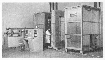
Bild 2. Ansicht der dreiteiligen k-Wert-Kammer mit Messpult und Eiswasserbehälter
