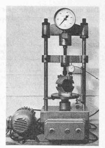
Bild 1. Marshall-Prüfgerät mit Prüfform und eingelegtem Prüfkörper
