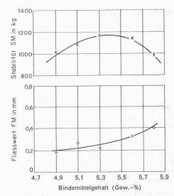
Bild 3. Stabilität und Fliesswert von Marshall-Prüfkörpern in Abhängigkeit vom Bindemittelgehalt
