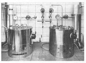
Bild 2. Metallblockbäder zur Bestimmung des Abdampfrückstandes
