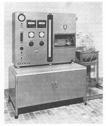
Bild 4. «Fuel Coker» zur Bewertung der Wärmestabilität
