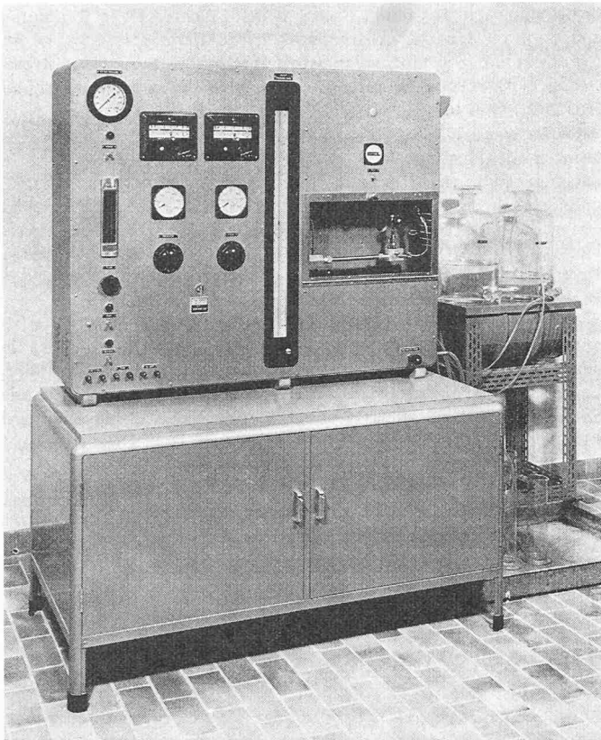
Bild 4. «Fuel Coker» zur Bewertung der Wärmestabilität
