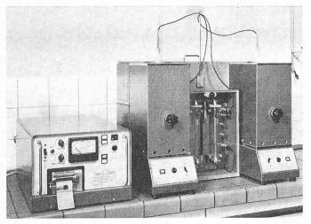
Bild 1. Automatische Apparatur zur Erstellung einer Siedeanalyse
