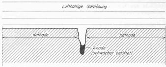
Bild 6. Spaltkorrosion (starker Angriff in schlecht «belüftetem» Spalt)
