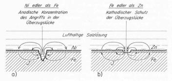
Bild 5. Korrosionsverhalten von mit undichten Metallüberzügen versehenen Stahlobjekten
