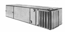
Lüftungsgeräte im Baukastensystem. An den Ventilatorbloc werden je nach Bedarf angebaut: Wärmeaustauscherbloc (mit Lufterhitzer und/oder Luftkühler), Filterbloc mit Mischklappen, Befeuchterbloc. Die Luftverteilung erfolgt durch Ausblasgitter am Gerät oder durch angebaute Kanäle. Der Ventilatorbloc lässt sich auch als Abluftgerät verwenden.
