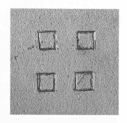
Bild 9 (links) Spritzzink auf Stahlblech, 0,2 mm dick. Prüfung mit der Meisselprobe. Einwandfreie Haftung des Überzuges
