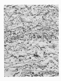
Bild 12 (links). Flammgespritzter rostfreier Stahl, stark mit Oxyden durchsetzt, ungeätzt. Vergrösserung 60fach
