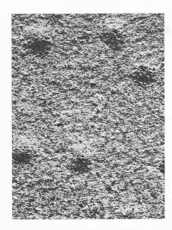
Bild 5 (links). Spritzverzinktes Stahlblech nach sieben Jahren Wasserlagerung. Blasen im Zinküberzug. Vergrösserung fünffach
