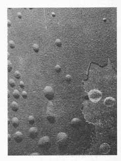
Bild 6 (rechts). Stahlrohr-Innenseite nach Wasserdruckprobe. Blasen im Zinküberzug. Rechts im Bild Überzug lokal abgeblättert. Natürliche Grösse
