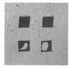
Bild 10 (rechts). Wie Bild 9, jedoch bei ungenügender Haftung des Überzuges
