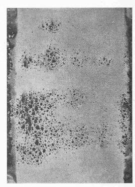
Bild 4 (rechts). Spritzverzinktes Stahlblech nach sechs Jahren Wasserlagerung mit Rostbildungen an Poren im Überzug
