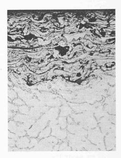
Bild 13 (rechts). Flammgespritzter Stahl auf Leichtmetallguss, Stahlschicht (oben) stark mit Oxyden durchsetzt, ungeätzt. Vergrösserung 60fach
