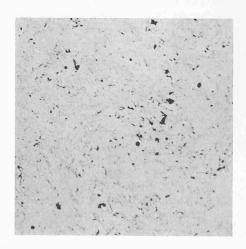
Bild 2 (rechts). Spritzzink, stark porig, ungeätzt, Vergrösserung 200fach
