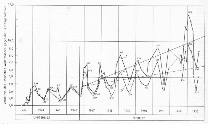
Bild 3. Ergebnisse von Messungen des ohmschen Widerstandes am Mauerwerk aus natürlichen Bausteinen des Chores der Predigerkirche in Zürich, ausgeführt durch die EMPA. Aufgetragen sind die Mittelwerte von drei Messstellen. Die Messungen begannen unmittelbar nach dem Auftragen eines neuen Verputzes
