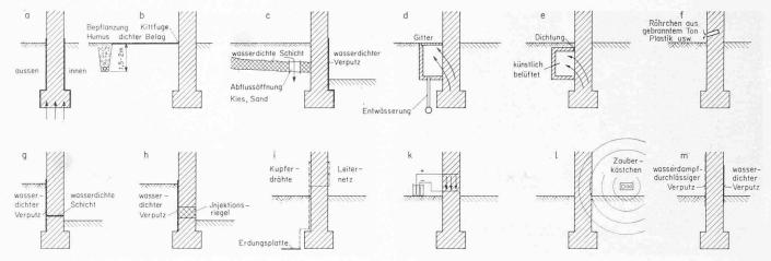
Bild 2. Beispiele für verschiedene Entfeuchtungsverfahren
