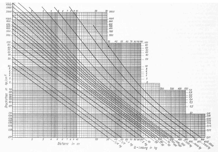
Bild 1. Luftstosswirkung (Druckstoss in kp/cm²) brisanter Explosionen auf normal zur Ausbreitung stehende Flächen in Abhängigkeit von der Distanz und der Ladung. (Über dem festen Halbraum an normal getroffenen Flächen reflektierter Luftstoss.)
