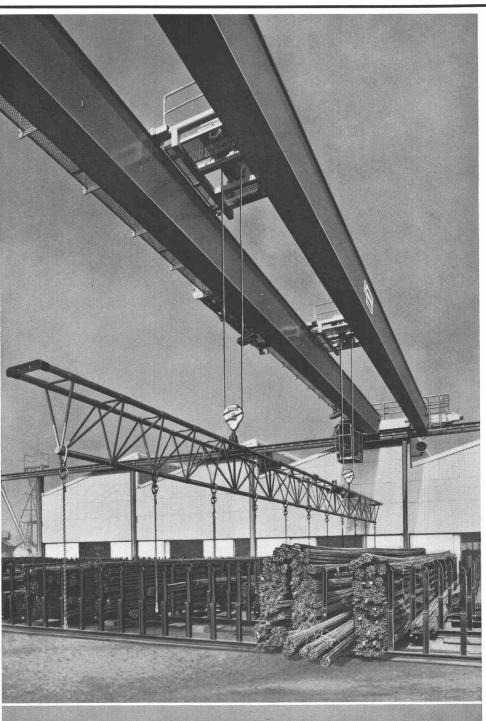
2-Träger-Laufkran, Tragkraft 10 t, Spannweite 33,5 m Zwei DEMAG-Elektrozug-Katzen mit je 5 t Tragkraft Hans Fehr AG Kranbau Dietlikon
