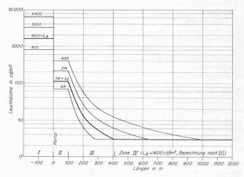
Bild 1. Leuchtdichte-Verlauf für Höchstgeschwindigkeit 80 km/h. Adaptationspunkt rund 25 m vor dem Portal. Anhaltestrecke nach SNV 40 130 a.  $L_A=\,$  Aussenleuchtdichte,  $L_T=\,$  Leuchtdichte im Tunnel
