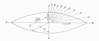
Bild 4. Theoretische Begrenzungslinie für horizontal liegende Raster, berechnet für  $\phi=47\,^\circ$  02,6' (Luzern) und  $\delta=23\,^\circ$  27,4' (21. Juni)
