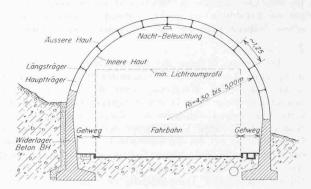
Bild 3. Rasterbauwerk, typischer Querschnitt 1:200
