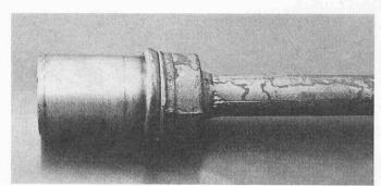
die erste Phase der Reibung zu überwinden. Wird die Spindel unter Axialdruck zugeschaltet, werden Antrieb und Motor mehr in Anspruch genommen. Kleinere Drehmomentenspitzen werden entstehen, wenn der Axialdruck erst allmählich aufgebaut wird. Bei Verwendung geeigneter Steuerung kann der ganze Ablauf mit einem fast gleichmässigen Drehmoment bewältigt werden.
