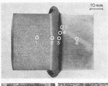
Bild 3. Makro- und Mikroaufnahmen der charakteristischen Gefüge einer Reibschweissung zwischen C 60 und D Mo 5
