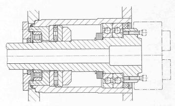
Bild 8. Konstruktion der Spindellagerung einer Reibschweissmaschine
