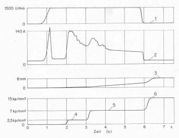
Bild 2. Verlauf der Schweissparameter bei einer Reibschweissung. Werkstoff C 45, Stabdurchmesser 30 mm
