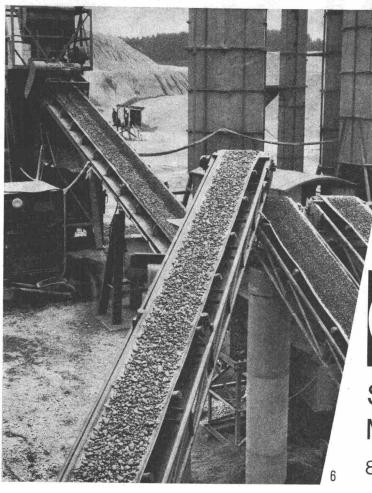
Die Belags- und Betonproduktion kann durch Einsatz geeigneter Förderbänder entscheidend rationalisiert werden. Hier verhelfen SSS-Förderbänder, zentral ferngesteuert und unaufhörlich strapaziert, zu einer konstanten hohen Produktion.
