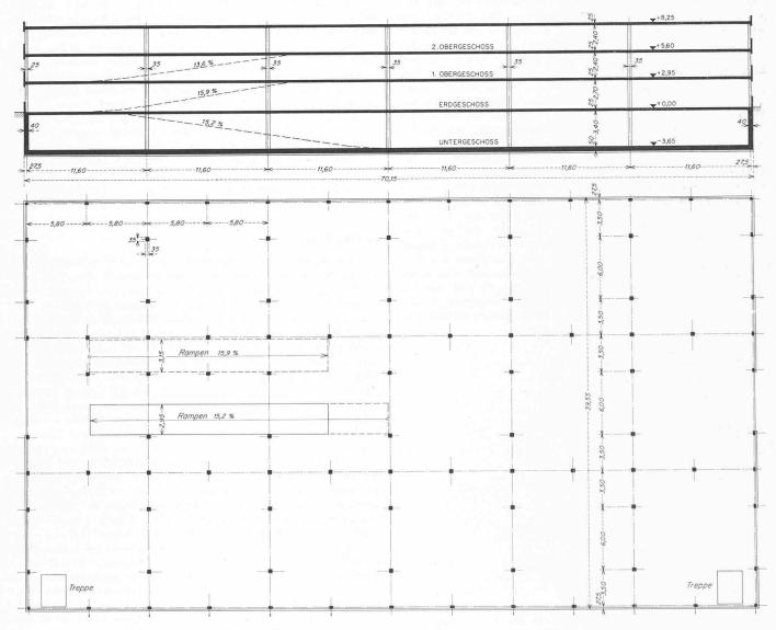
Bild 1. Längsschnitt und Grundriss Erdgeschoss, 1:400
