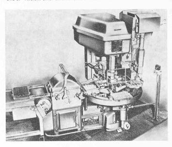
an der Füllrutsche befestigter Rahmen drückt den Sand seitlich an die Form an; die hierfür benötigte Kraft wird durch Druckluft aufgebracht.
