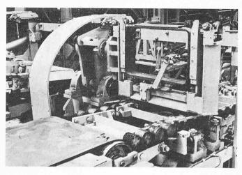
Bild 5. Die Giesspfanne ist an einem drehbaren Ausleger über dem Giesskarussell angebracht
