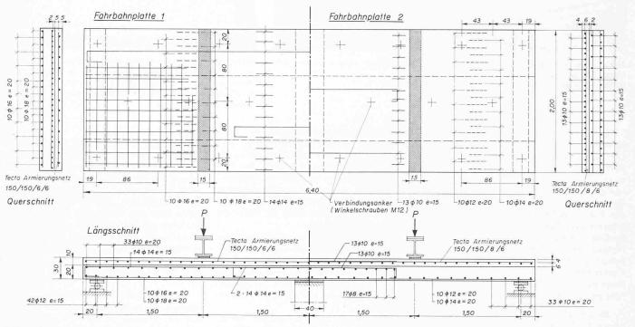
Bild 2. Belastungsanordnung und Armierungspläne der untersuchten Verbundplatten. Links Platte 1, rechts Platte 2
