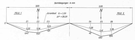
Bild 6. Gemessene Biegelinien an den beiden Versuchsplatten unter statischer Nutzlast  $N=21\,t.$  Oben Fahrbahnplatte 1: Vergleich ohne und mit Betondeckbelag, vor und nach zwei Millionen Lastpulsationen mit der vollen Nutzlast. Unten Fahrbahnplatte 2: Vergleich Verbundplatte vor und nach zwei Millionen Lastpulsationen mit der vollen Nutzlast
