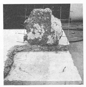
Bild 5. Weggetrennte und abgehobene Eckpartie des Deckbelages nach dem statischen Bruchversuch von Platte 1.
