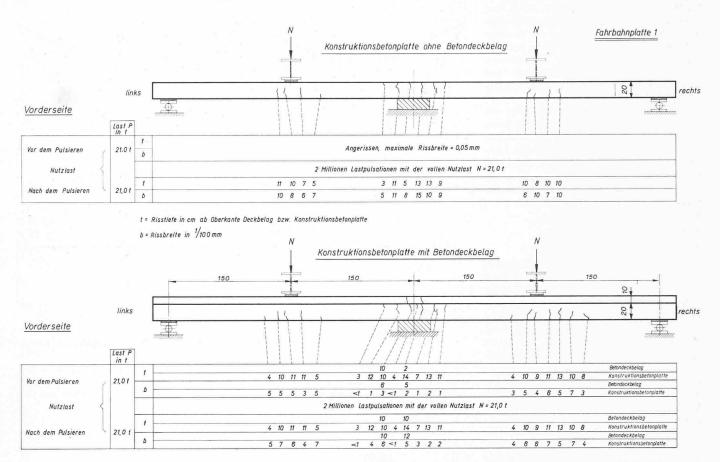
Bild 9a. Fahrbahnplatte 1: Vorderseite der Konstruktionsbetonplatte, welche vorgängig ohne Deckbelag pulsiert wurde; Vorderseite der Verbundplatte
