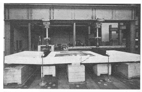
Bild 8. Bruchzustand von Verbundplatte 2 nach dem statischen Bruchversuch im Anschluss an die Ermüdungsversuche. Biegeschubbruch im Feld 2 (rechts):  $P_{Br}=91.0$  t entsprechend einer noch vorhandenen statischen Bruchsicherheit von 4,0. Anschliessend noch Biegebruch bei Belastung von Feld 1 allein (links) mit 74,2 t
