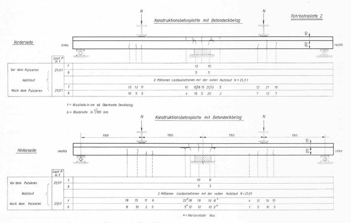
Bild 9b. Fahrbahnplatte 2: Vorderseite und Hinterseite der Verbundplatte
