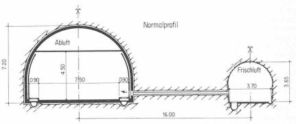
Bild 3. Projekt mit zwei Schächten und Seitenstollen, Längenprofil und Normalprofil
