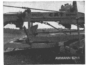
Drehkranz, solid, grosser Durchmesser
