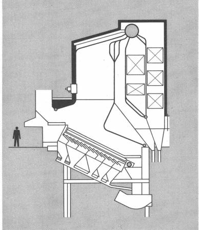
Kehrichtverbrennungsanlage in der Schweiz. Leistung: 12,4 t/h, 46 atü, 400°C, 12,9 m² Rostfläche Max. Müllmenge 5 t/h, Heizwert max. 2200 kcal/kg.
