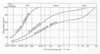
Bild 14. Kornverteilung der Untergrundmaterialien in Summationskurven
