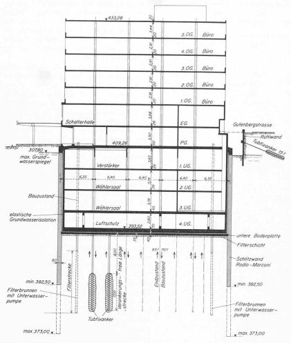
Bild 2. PTT-Betriebsgebäude Zürich-Enge, Querschnitt 1:500 durch Bürotrakt
