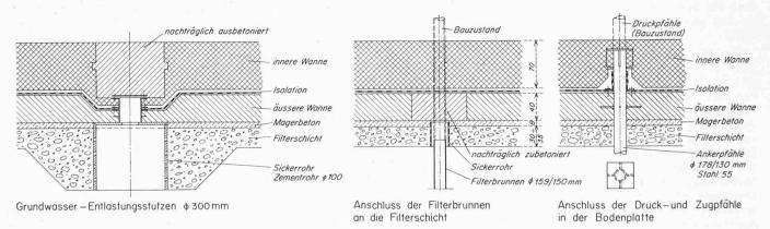
Bild 7. Einzelheiten von Anschlüssen in der Bodenplatte, Massstab 1:60
