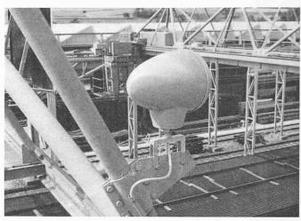
Bild 2. Gehäuse, in welchem Radar-Sender oder -Empfänger eingebaut sind
