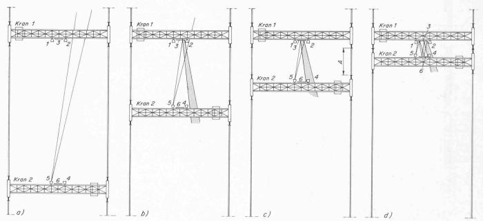
Bild 3. Schematische Darstellung der Funktion einer Radar-Zusammenfahrsicherung für eine Zwei-Kran-Anlage. 1 und 4 Empfänger, 2 und 5 Sender, 3 und 6 Reflektor
