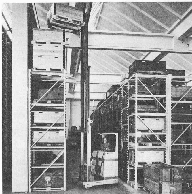
Bild 2. Der SIG-Lifter Modell RFQ 1602 t stapelt 1000 kg schwere Lasten in nur 2,10 m breiten Gängen auf 6 m Höhe. Das stufenlose Arbeiten eines Impulsfahrschalters erlaubt feinfühliges Manövrieren
