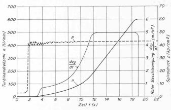
Bild 7. Drehzahl, Spiraldruck und Rotorbeschleunigung beim Anfahren der Grossanlage in Funktion der Zeit
