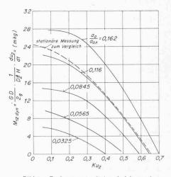
Bild 5. Drehmomente beim Anfahren der Modellturbine
