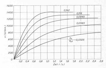
Bild 3. Anfahrkurven der Modellturbine bei verschiedenen Leitradöffnungen
