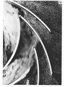
Bild D. Strömung im Leitrad bei Überlast;  $\alpha_1=14$  ° Bild E. Strömung im Leitrad bei Vollast;  $\alpha_1=14$  °
