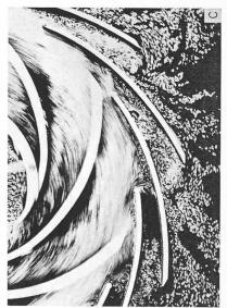
Bild A. Strömung im Leitrad bei Überlast;  $\alpha_1=$ Bild B. Strömung im Leitrad bei Vollast;  $\alpha_1=$ Bild C. Strömung im Leitrad bei Teillast;  $\alpha_1=$
