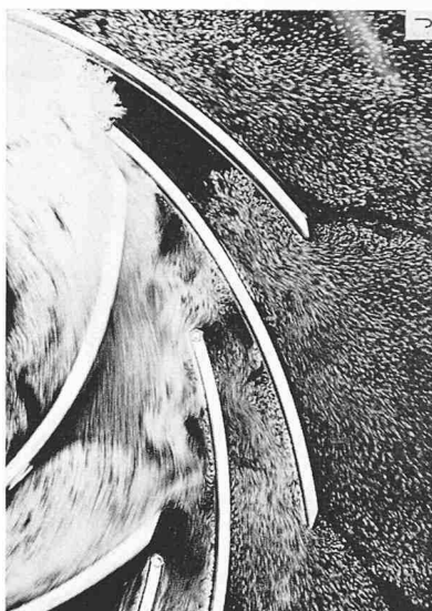
Bilder F (mittlere Reihe unten) und G bis J. Strömung im Leitrad bei Teillast; \alpha_1 = 14^\circ
