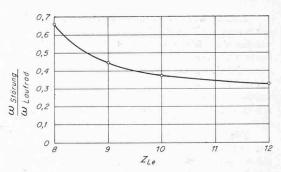
Bild 4. Umlaufgeschwindigkeit der Störungen in Abhängigkeit von der Leitschaufelzahl
