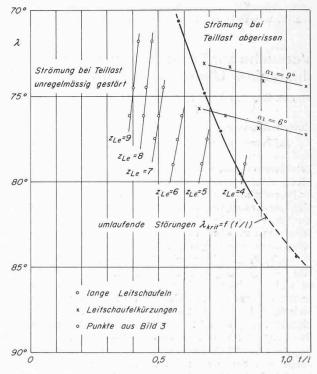
Bild 5. Auftreten umlaufender Störungen in Abhängigkeit vom Staffelungswinkel, vom Verhälnis t/l und von der Schaufelzahl
