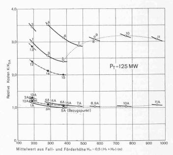
Bild 5. Relative Kosten von Pumpspeichersätzen mit  $P_{\it T}=$  125 MW in Abhängigkeit von der Fallhöhe und der Bauart, ohne Verlustbewertung. Bezugspunkt: Kosten der Synchronmaschine Variante 5 A 8. Die untere Kurvenschar zeigt die Kosten der Synchronmaschinen allein (Varianten A), die obere die der kompletten Maschinensätze einschliesslich der Abschlussorgane. Die Nummern bezeichnen die Varianten (nach Bild 1 und Tabelle 2)
