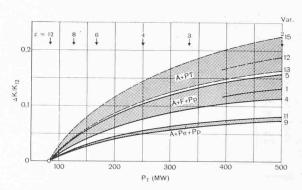
Bild 4. Verringerung der relativen Kosten der Maschinensätze einschliesslich der Abschlussorgane bei steigender Einheitsleistung durch die Kapitalisierung der Wirkungsgrad-Aufwertung
