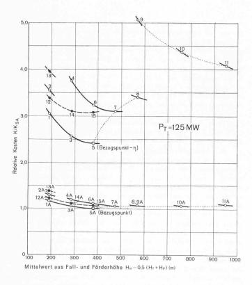
Bild 6. Relative Kosten von Pumpspeichersätzen mit  $P_T=$  125 MW in Abhängigkeit von der Fallhöhe und der Bauart, **mit** Verlustbewertung. Bezugspunkt für Kosten: Variante 5 A 8. Bezugspunkte für die Wirkungsgrade: Varianten 5 F 8, 5 Pp 8. Bezeichnungen wie in Bild 5
