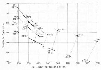
Bild 1. Angenommene spezifische Drehzahlen  $n_q$  in Abhängigkeit von der Fall- bzw. Förderhöhe  ${\cal H}$
