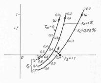
Tabelle 1. Die für unverzögerten PI-Regler mit der Zeitkonstante  $T_m=0$  berechnete Stabilitätsmarge wird nach den Bildern 4 und 5 bei kleinerer Eingangsamplitude  $x_0=0,25\,\%$  gegen  $x_0=1\,\%$  zunehmend aufgezehrt, so dass kleinere Frequenzabweichungen als  $x=\pm\,0,25\,\%=\pm\,0,125$  Hz nur schleichend abklingen mit 29 statt 4,25 Halbschwingungen in 230 statt 33,3 s.
