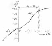
Bild 2. Servomotorgeschwindigkeit m' in Abhängigkeit von der Frequenzabweichung x. Infolge des nichtlinearen Anstiegs von m' mit x, wird bei einer hohen Eingangsamplitude  $x_0=1$  °/0 der aufgedrückten Sinusschwingung der Abklingvorgang nicht bis auf kleinste Abweichungen x richtig erfasst; hier liess sich das Abklingverhalten im Gebiet kleinster Abweichungen x mit Hilfe einer vom O-Punkt ausgehenden linearisierenden Tangente t rechnerisch bestimmen.
